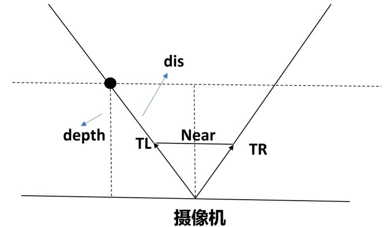
我们可以利用相似三角形的原理，推导出深度值和两点之间距离（欧式距离）的关系。
